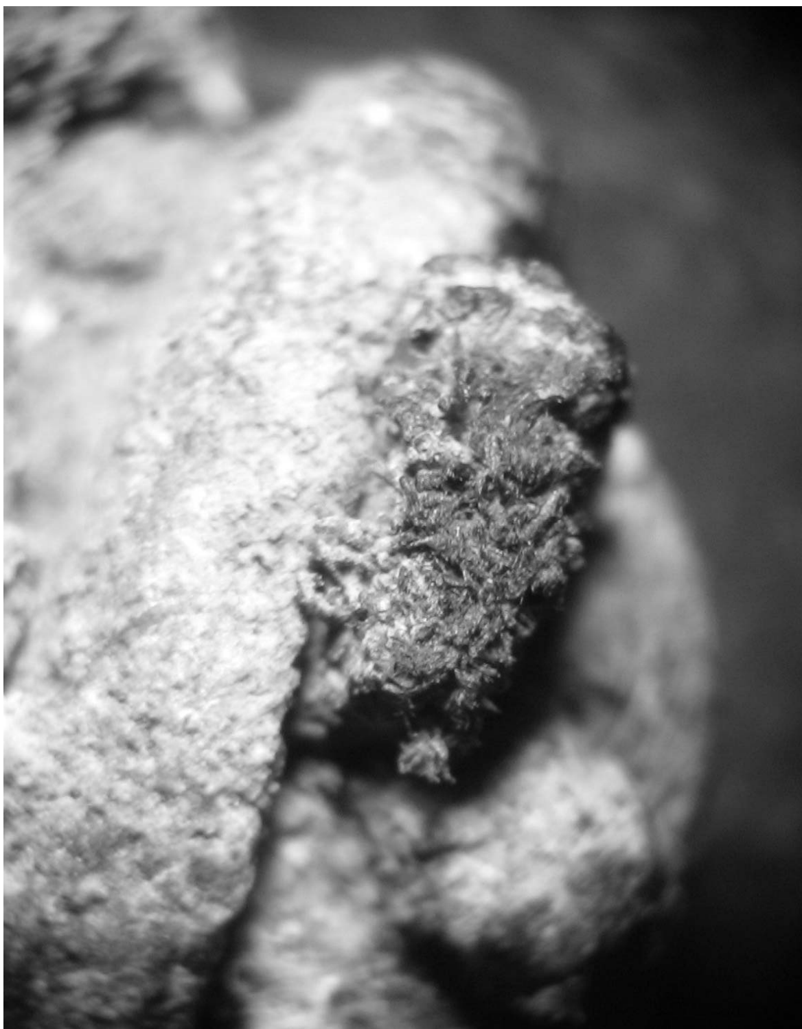
Figura 4. Detalle del extremo roto por sobre-tensión, obsérvese las fibras por la rotura.
